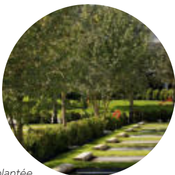
Noue plantée récupérant les eaux de ruissellement du parking
